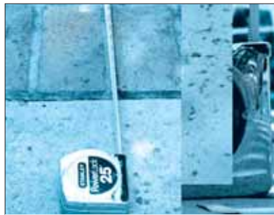
▲ شکل ۳. متر از یک پهلو بر روی زمین قرار گرفته است و ساختار فنری آن را به درون بدنه می‌کشد. وقتی نوار کاملاً به درون بدنه کشیده شود، چه اتفاقی خواهد افتاد؟
